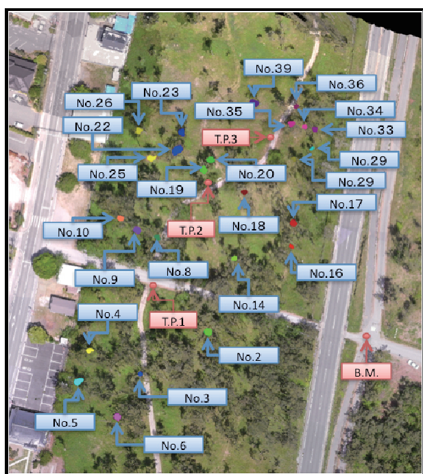
図 8：毎木調査地点およびトータルステーション据え付け位置 (No.：毎木調査地点, B.M.：座標原点, T.P.：盛り替え点)
