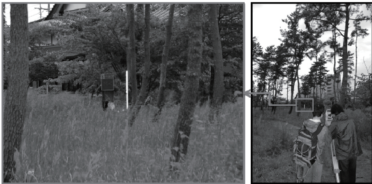
図 7：トータルステーションによる毎木調査地点の位置測量 (T.P. 1 から No. 5 を視準)
