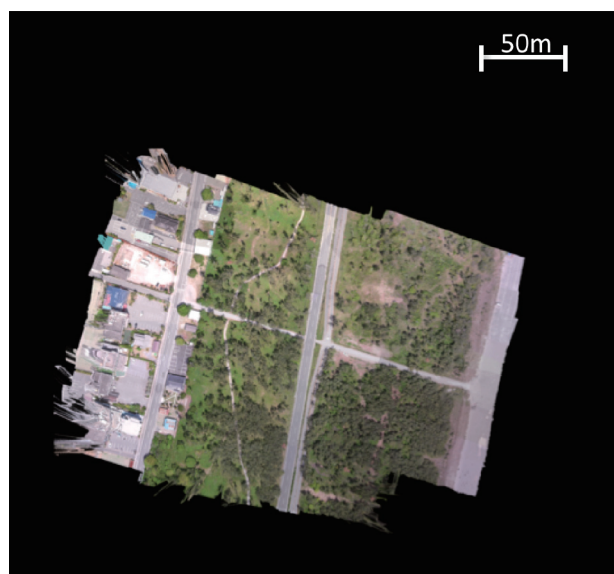
図 5：DSM を利用したオルソモザイク画像
