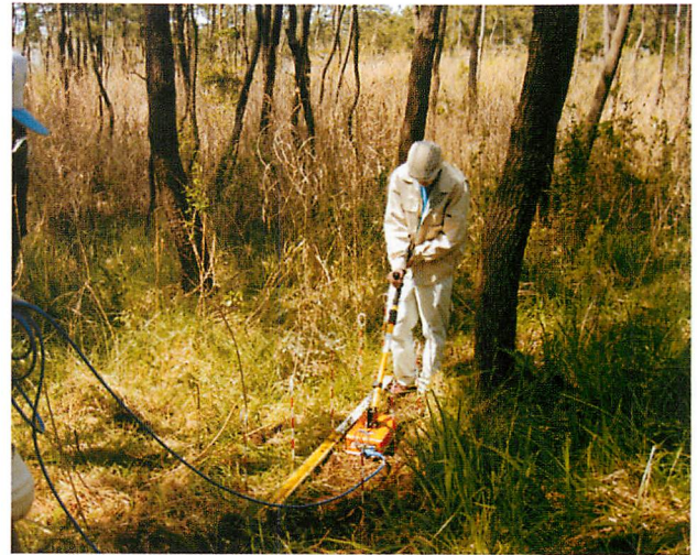
写真3 地中レーダの現地探査状況
