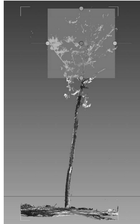
図4 地上LiDARデータから抽出された単木と樹冠計測。（樹冠に直方体をあてはめると各点の座標が出力される）
